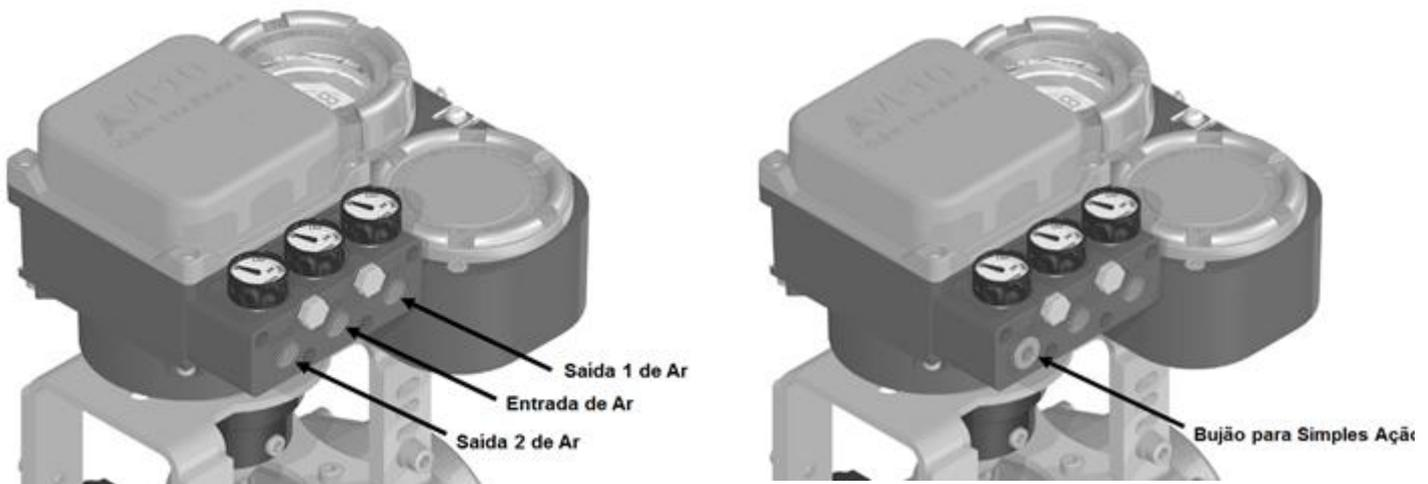
Além disso, o posicionador possui duas tomadas de pressão em uma de suas laterais, para ajuste da pressão piloto. A Altus fornece o manômetro e dispositivo específico para esta calibração como itens opcionais. Veja mais informações sobre este procedimento no manual específico de manutenção do posicionador, disponível no website.
