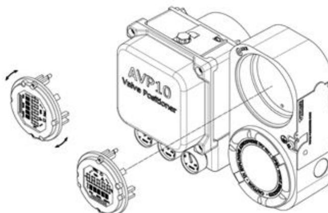
A instalação do ímã de referência do posicionador AVP10 no sistema desejado deve ser feita primeiramente posicionando o mesmo ao sistema, de forma a permitir que o sensor possa percorrer toda a extensão útil a ser medida e alinhando a seta do ímã com a seta do posicionador na posição central (50% do curso) onde ficará localizado o sensor (seta na parte inferior da carcaça do posicionador).
