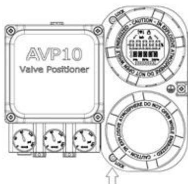
Para acessar a borneira é necessário remover a tampa cega (sem visor) do AVP10. Para tanto, solte o parafuso de trava da tampa, girando-o no sentido horário.
