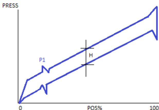
Exemplo de FST em sistema simples ação para modelo sem sensor de pressão:
