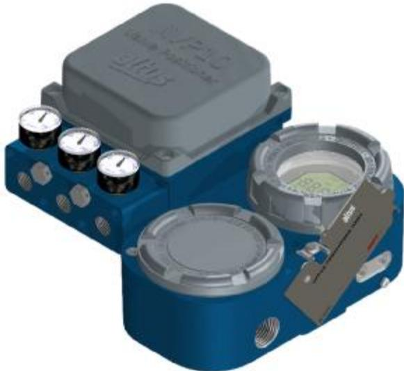
O posicionador AVP10 HART é integrante da família de equipamentos HART® da Altus, projetado para trabalhar com acionadores de válvula linear ou rotativa, proporcionando precisão e controle com alta disponibilidade e confiabilidade. Permite fácil instalação e comissionamento e é adequado para vários tipos de válvulas, independentemente da ação (simples ou dupla) e tamanho.
