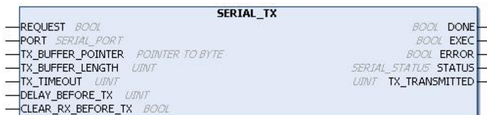
Figura 141: Bloco para Transmitir Valores pela SERIAL_TX
