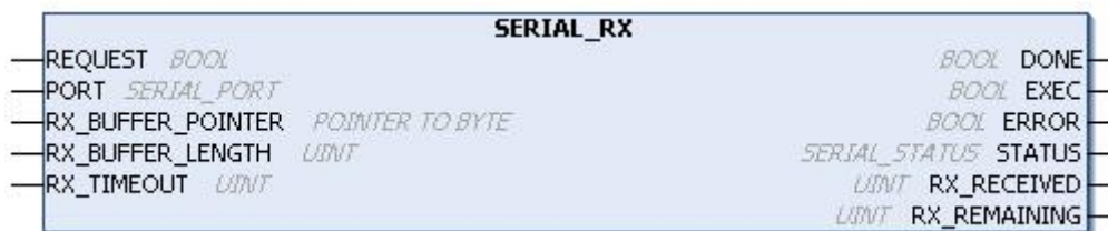
Figura 138: Bloco para Ler Valores do Buffer de Recepção
