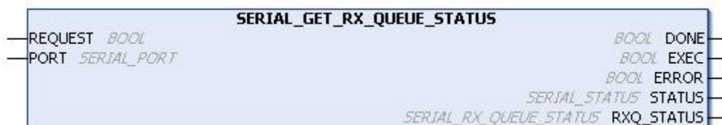
Figura 136: Bloco para Visualizar o Status da Fila RX
