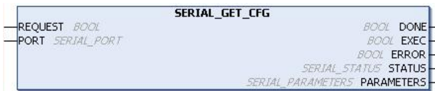
Figura 134: Bloco para Capturar a Configuração da Serial
