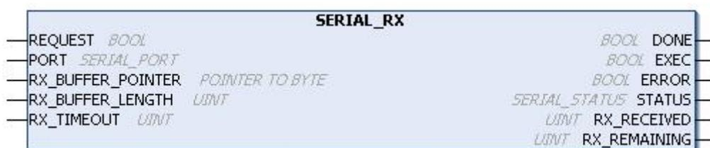
Figura 159: Bloco para Ler Valores do Buffer de Recepção
