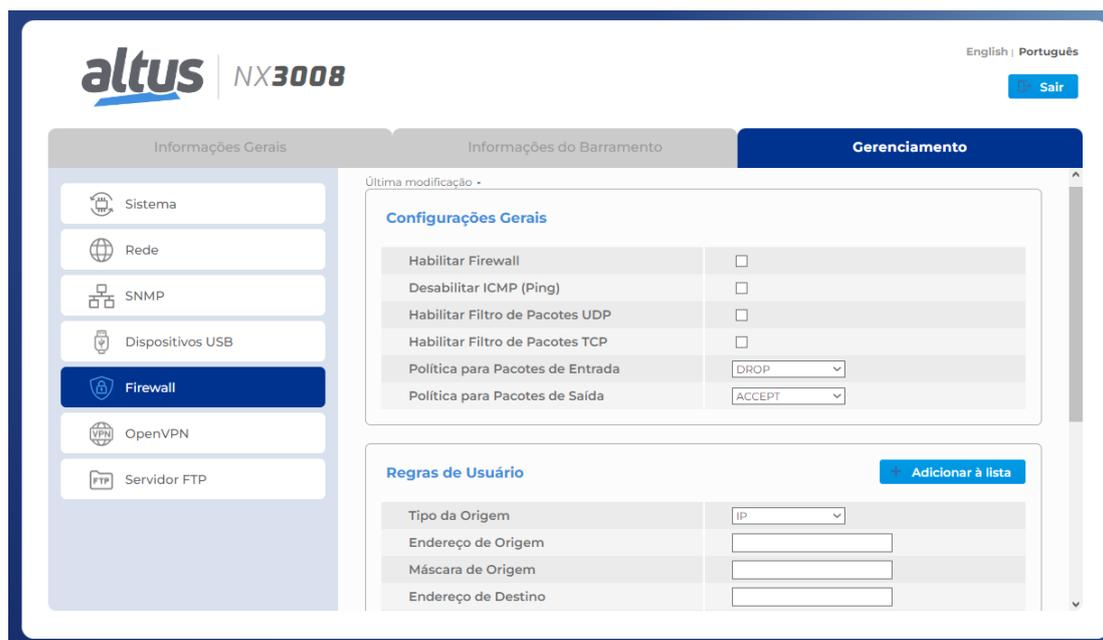
Figura 176: Tela de Configuração do Firewall
