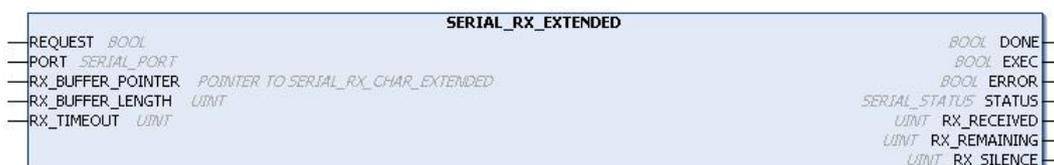
Figura 160: Bloco para Leitura do Buffer de Recepção
