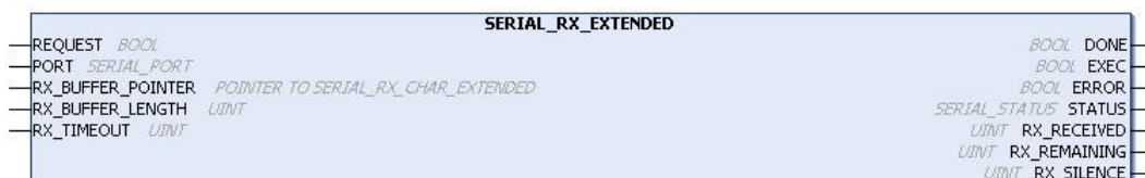
Figura 109: Bloco para Leitura do Buffer de Recepção
