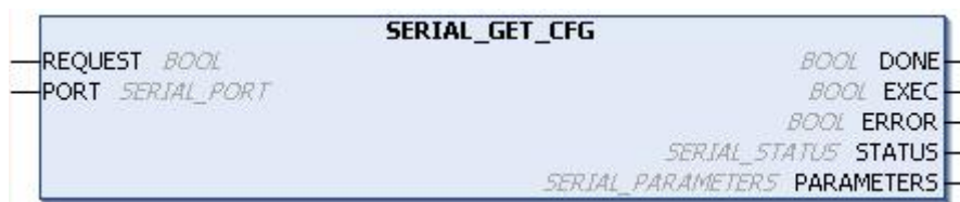
Figura 104: Bloco para Capturar a Configuração da Serial
