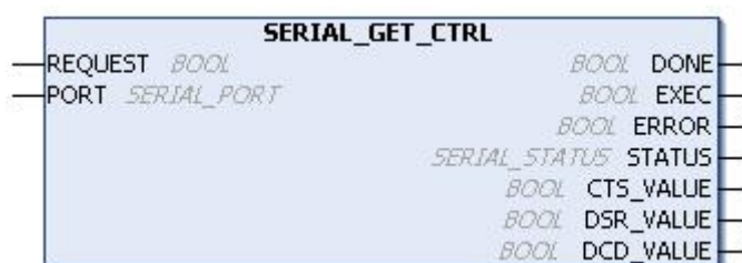
Figura 105: Bloco para Visualizar os Sinais de Controle
