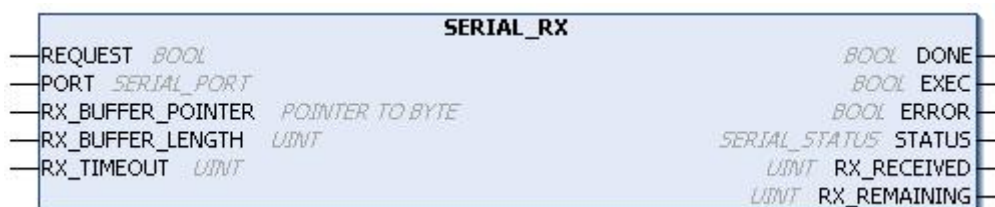
Figura 108: Bloco para Ler Valores do Buffer de Recepção
