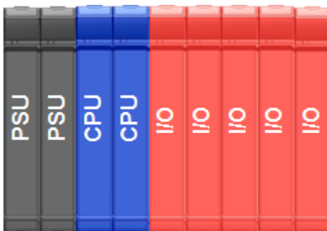
Figura 10: Redundância de UCP e Módulo Fonte de Alimentação
