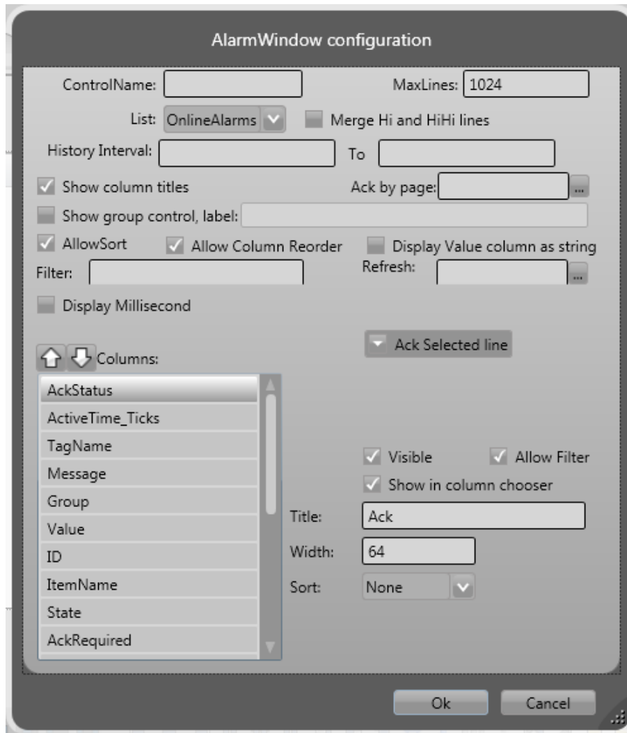
Figura 6-83. Configuração da Janela de Alarme
