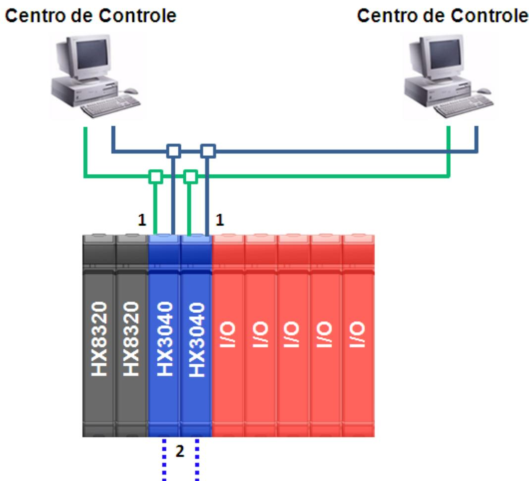
Figura 1: Redundância de UCP no mesmo Bastidor
