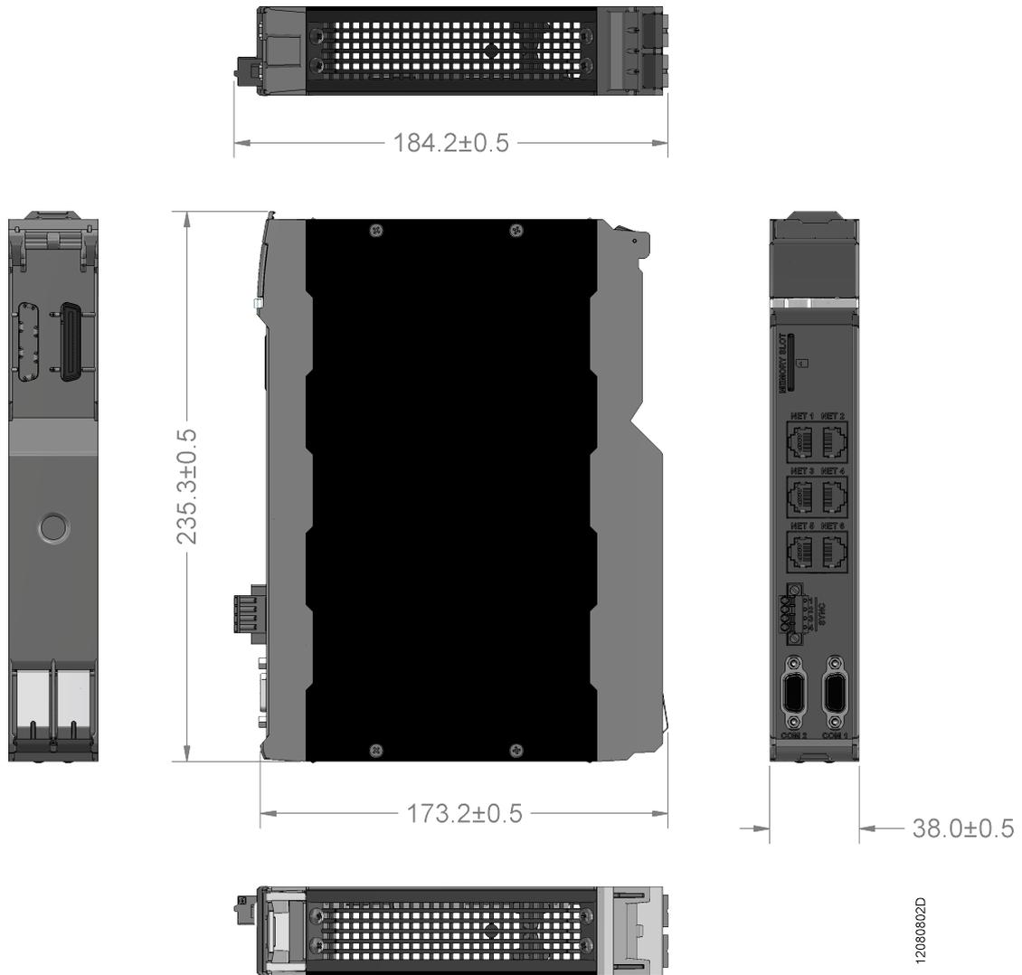
Figura 2: Dimensões Físicas
