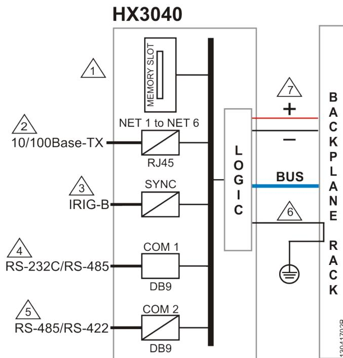
Figura 4: Diagrama Elétrico
