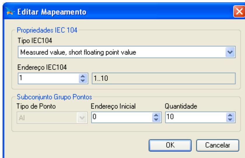
**Figura 7-9. Janela de edição de um mapeamento de grupo de pontos de comunicação**
