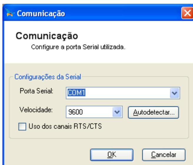
**Figura 9-3. Janela de configuração e seleção do canal serial**
