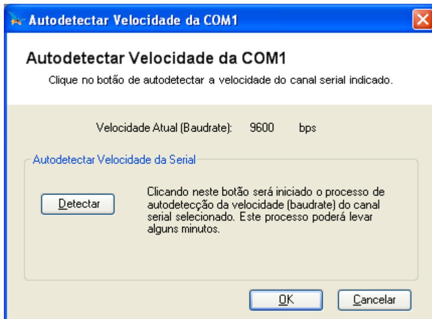
**Figura 9-4. Autodetectar velocidade do canal serial**
