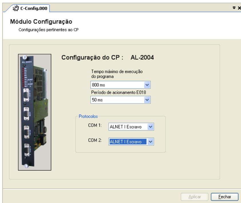
**Figura 6-19. Configurando os canais seriais do AL-2004**
