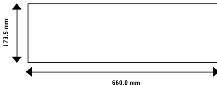
Figura 2-7. Dimensão dos barramentos 2 a 9
