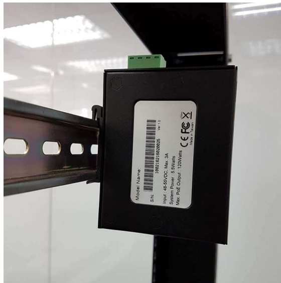
Figura 12: Estabilize o conversor de mídia no trilho DIN
