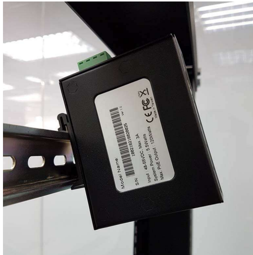
Figura 11: insira o conversor de mídia no trilho DIN
