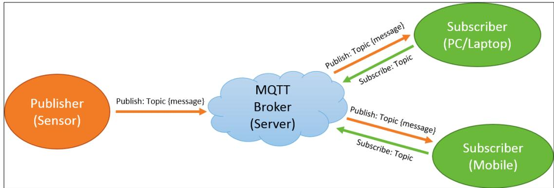
Figura 3-55. Esquema de uma Aplicação MQTT
