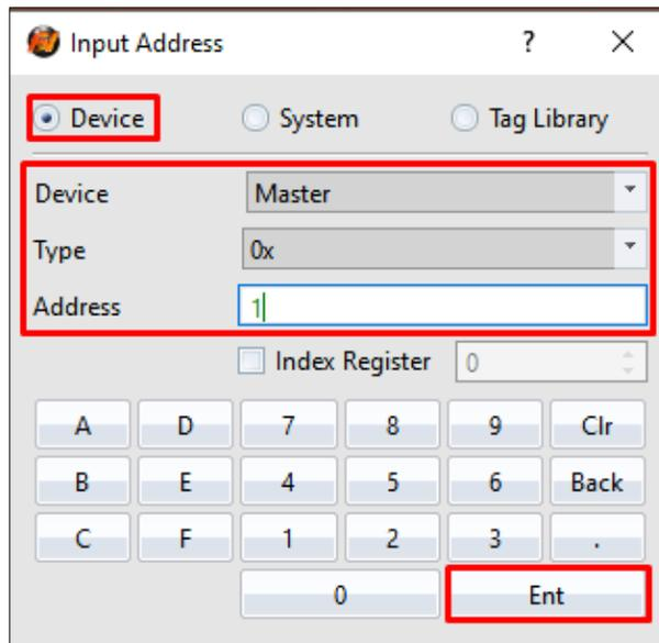
Figura 5-134. Definição do Tipo/Endereço Modbus TCP/IP
