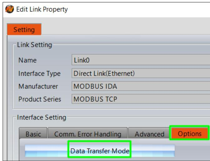
Figura 5-130. Modo de Transferência de Dados no Modbus TCP/IP
