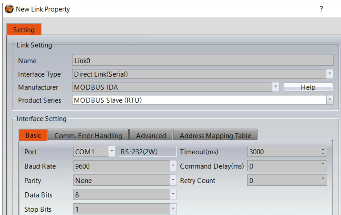
Figura 5-145. Configuração do Link Modbus Escravo
