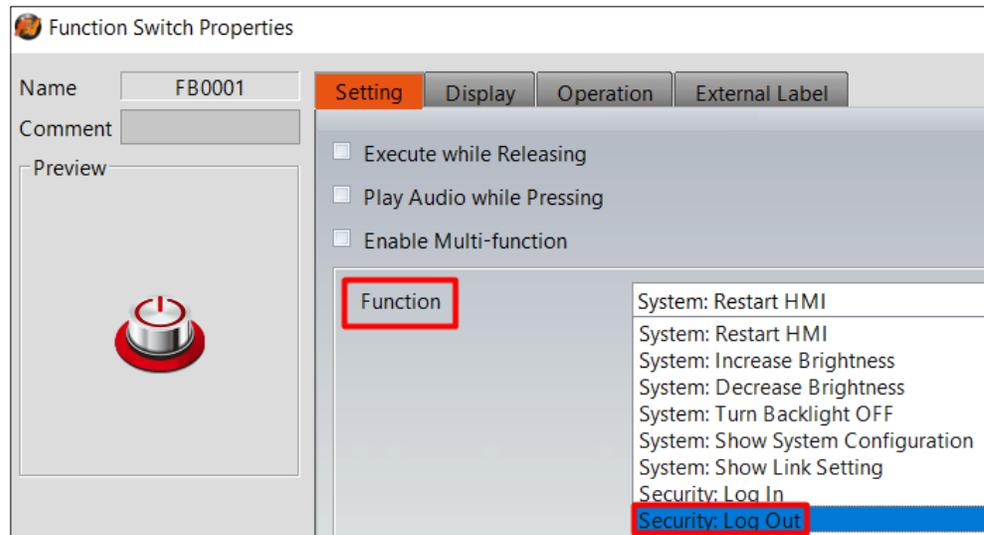
Figura 5-68. Configuração do objeto Tecla de Função (Log Out)
