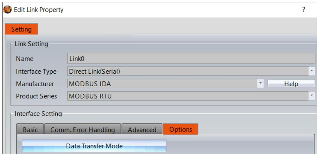
Figura 5-152. Definição do Modo de Transferência de Dados no Modbus RTU
