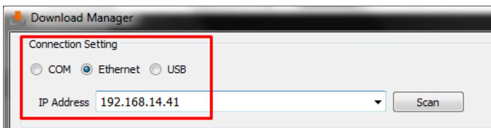
Figura 5-10. Configuração da conexão Ethernet
