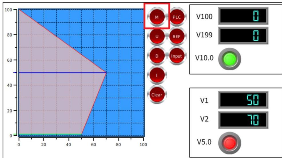
**Passo 8** - Pressione o *Subswitch* referente à saída para o controlador (PLC), você verá que o valor é gravado no endereço definido pela curva de interpolação.
