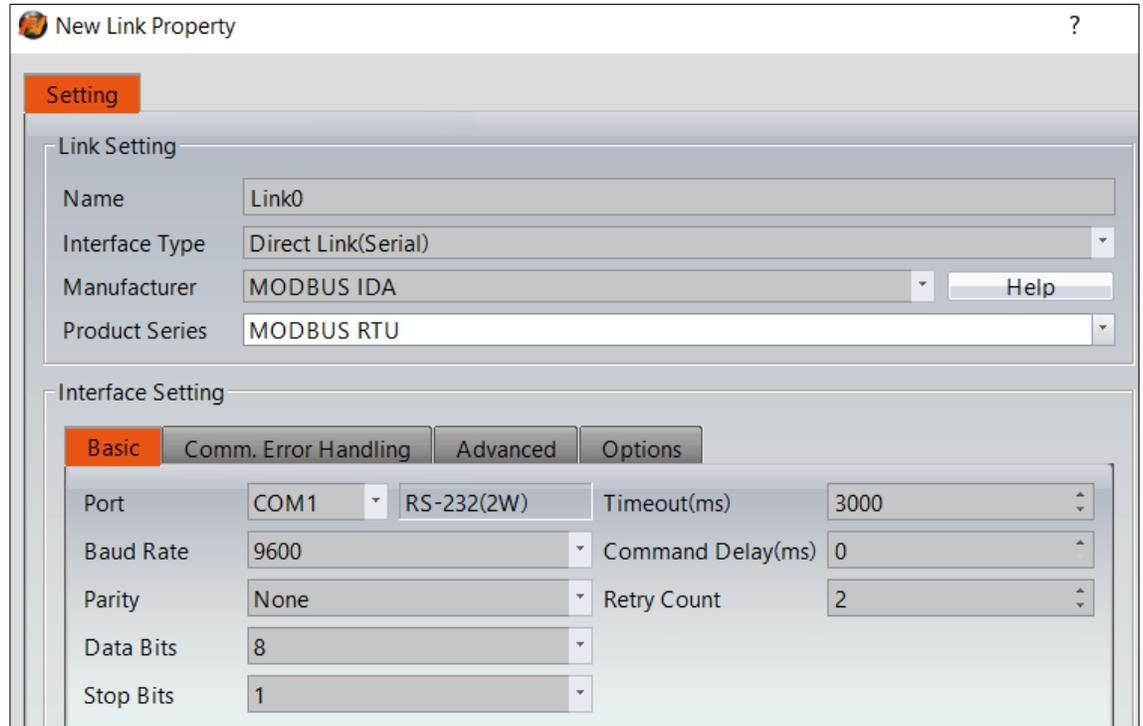
Figura 5-143. Configuração do Link Modbus Mestre
