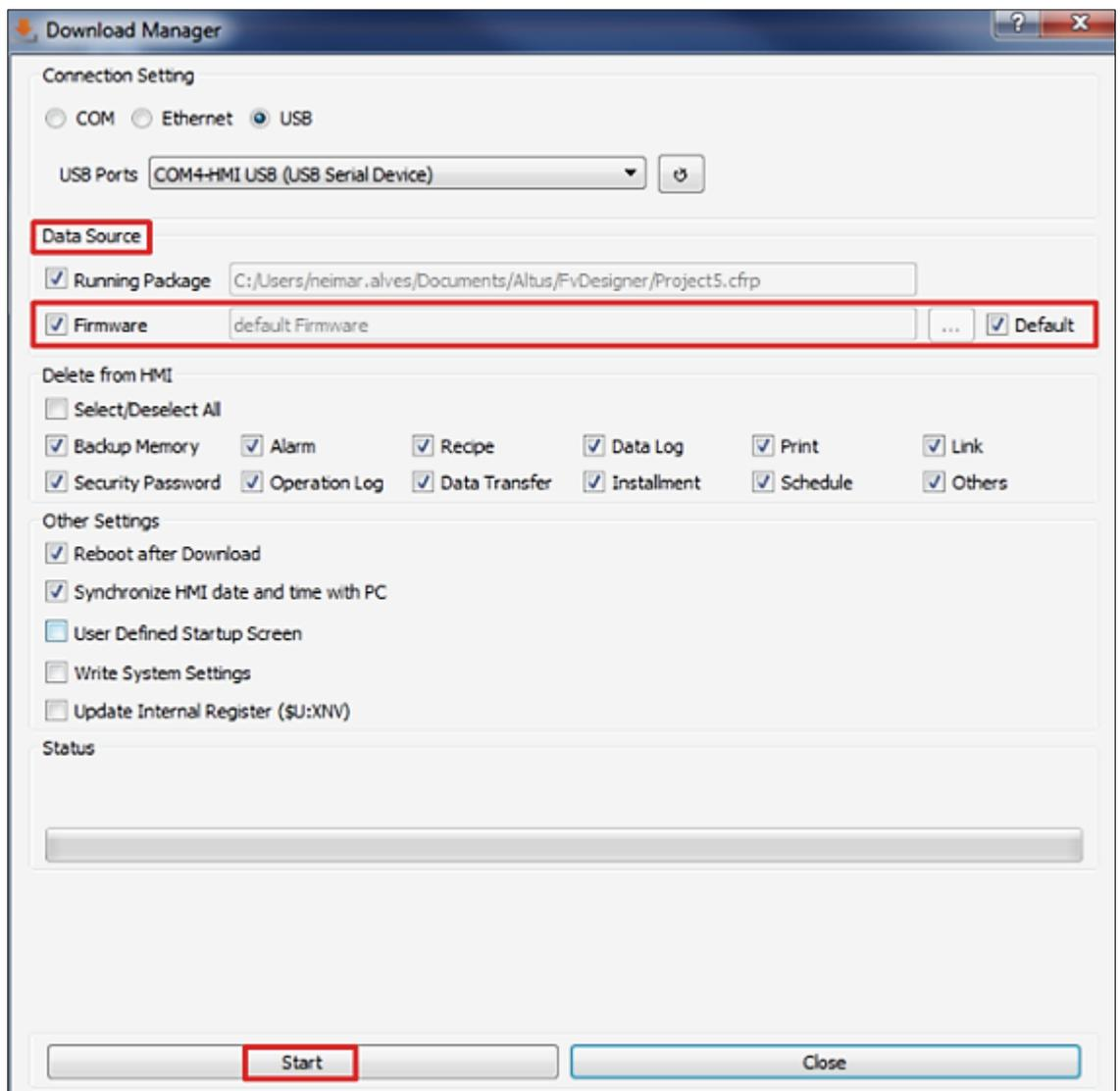
Figura 5-14. Opções para conexão via USB
