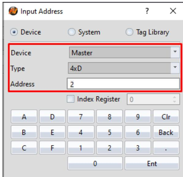
Figura 5-138. Definição do Tipo/Endereço Modbus TCP/IP
