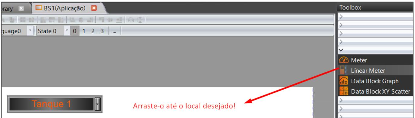
Figura 5-32. Inserção do objeto Medidor Linear
