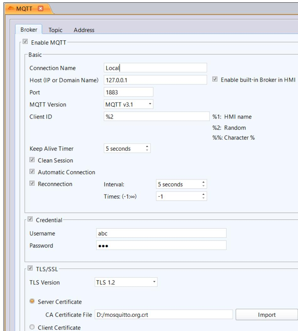
Figura 3-56. Aba de configuração do Broker MQTT
