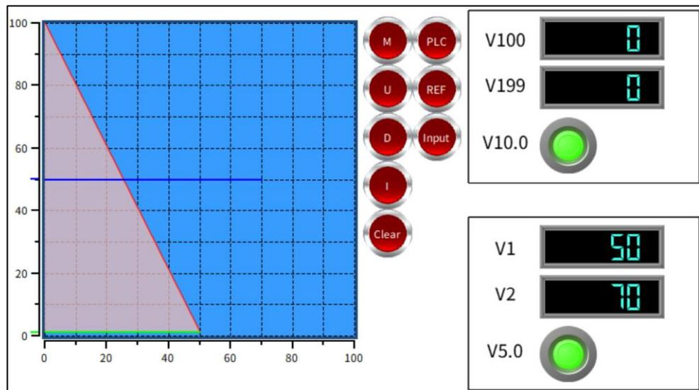
**Passo 7** - Pressione o *Subswitch* do ponto mestre (M), então você verá que o gráfico foi alterado conforme mostrado na sequência e o endereço da V5.0 também será ativado porque o valor 50 se tornará o estado do ponto mestre.
