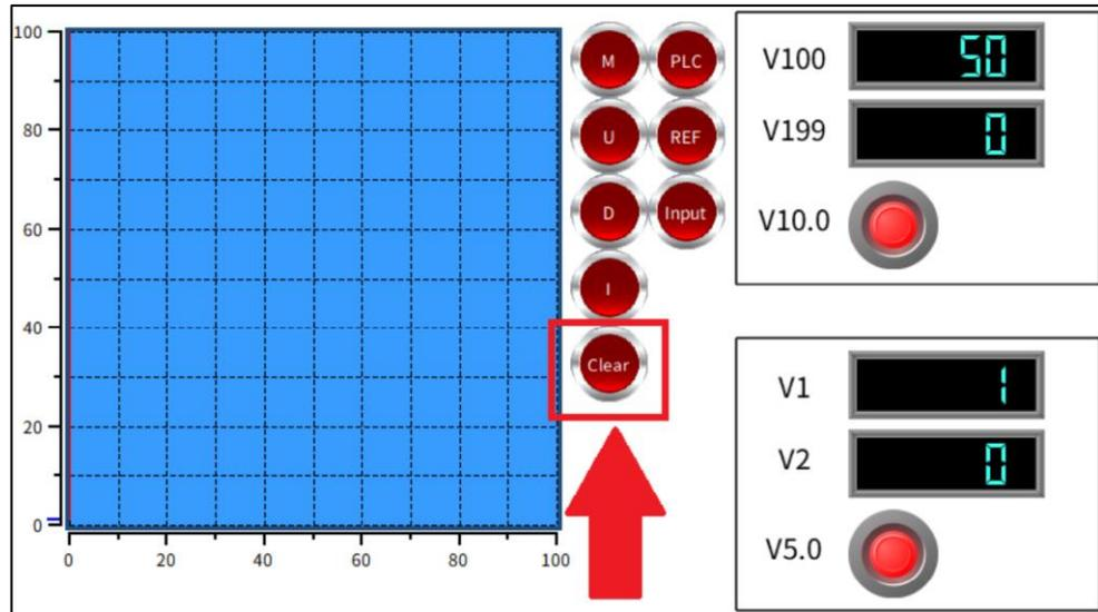
**Passo 12** – Pressione o *Subswitch Input* para inserir a interpolação no Parison, e o valor na etapa 8 será lido novamente.
