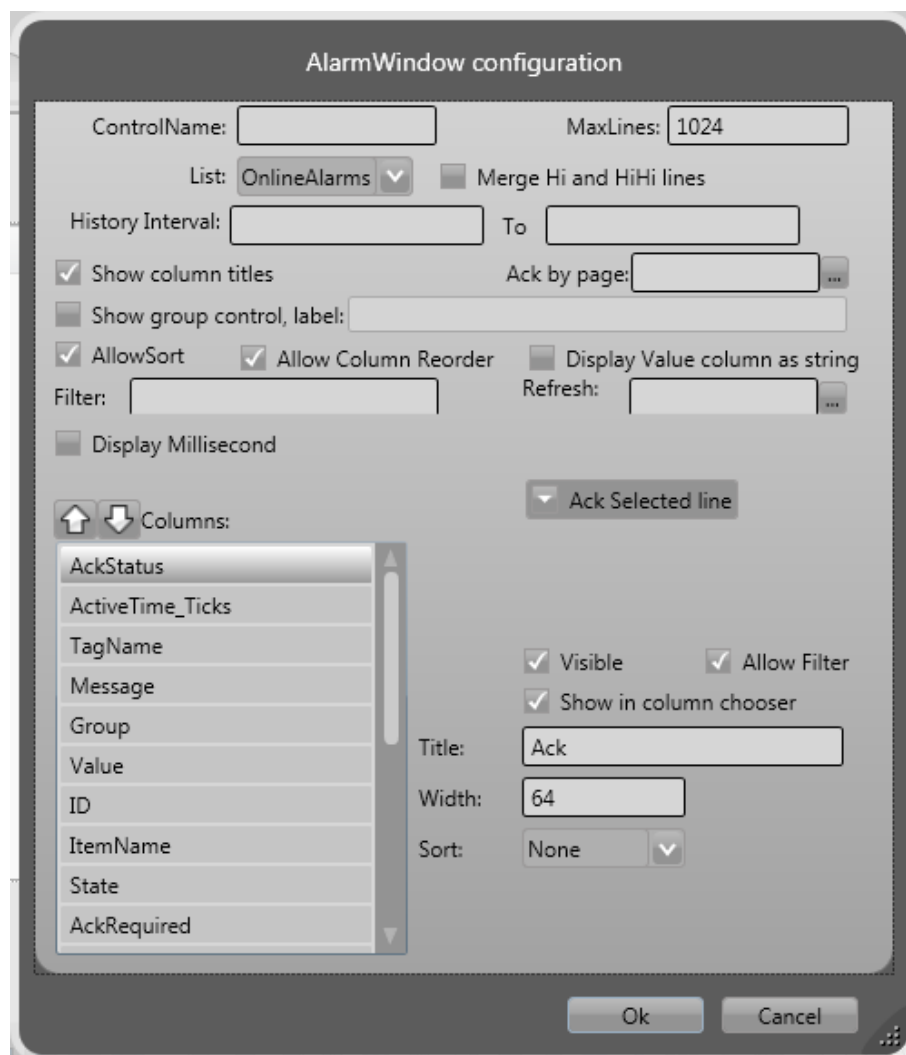
Figura 4-12. Configuração da Janela de Alarme
